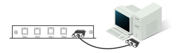
**串口:** 用于通过串口输出 685 协议,通过此串口可以与第三方软件无缝对接(第三方无需修改或订制开发软件),目前可以支持丛文、迈特安、霍尼韦尔等所有支持 685 电话线接警机的软件,通讯速率为 9600bps!
